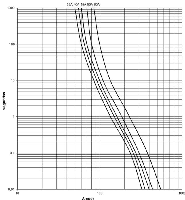
Los fusibles DELTA clase G para 480 VAC (300 VDC) están diseñados en conformidad con la norma americana UL198C.
