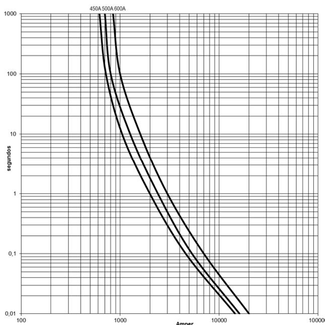
Los fusibles DELTA del tipo renovable modelo RNV60 tipo cuchillas para 250 VAC están diseñados en conformidad con la norma americana UL198B.
