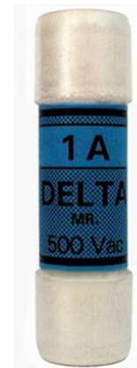
Son de acción lenta aM, especialmente diseñados para la protección de motores, solamente operan bajo corrientes de cortocircuitos. Las intensidades de hasta diez veces la nominal (10 In) deben ser desconectadas por los aparatos de protección propios del motor, mientras que las intensidades superiores deberán ser interrumpidas por los fusibles aM.
