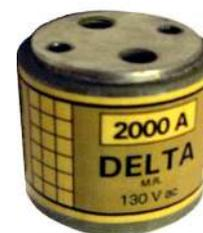
Los terminales son de una pieza torneada en bronce terminada con un baño de plata electrolítica, siendo el elemento fusible de plata con un 99.99% de pureza y se encuentra rodeado con arena de sílice con tratamiento de purificación magnética.
