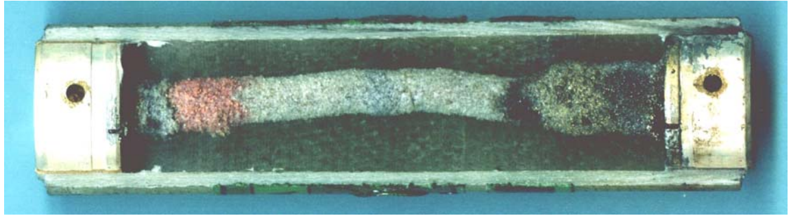
Fig. 3.4f. Trozo de fulgurita en el interior de un fusible de 750 V dc.
